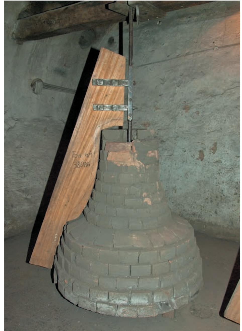
*Aufgemauerter Kern einer Glockenform und Schablone mit der Kontur der Rippe*
