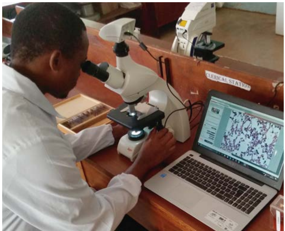
Beim Mikroskopieren der Zell-Präparate: Die Digitalkamera überträgt die Bilder direkt auf den Computer
